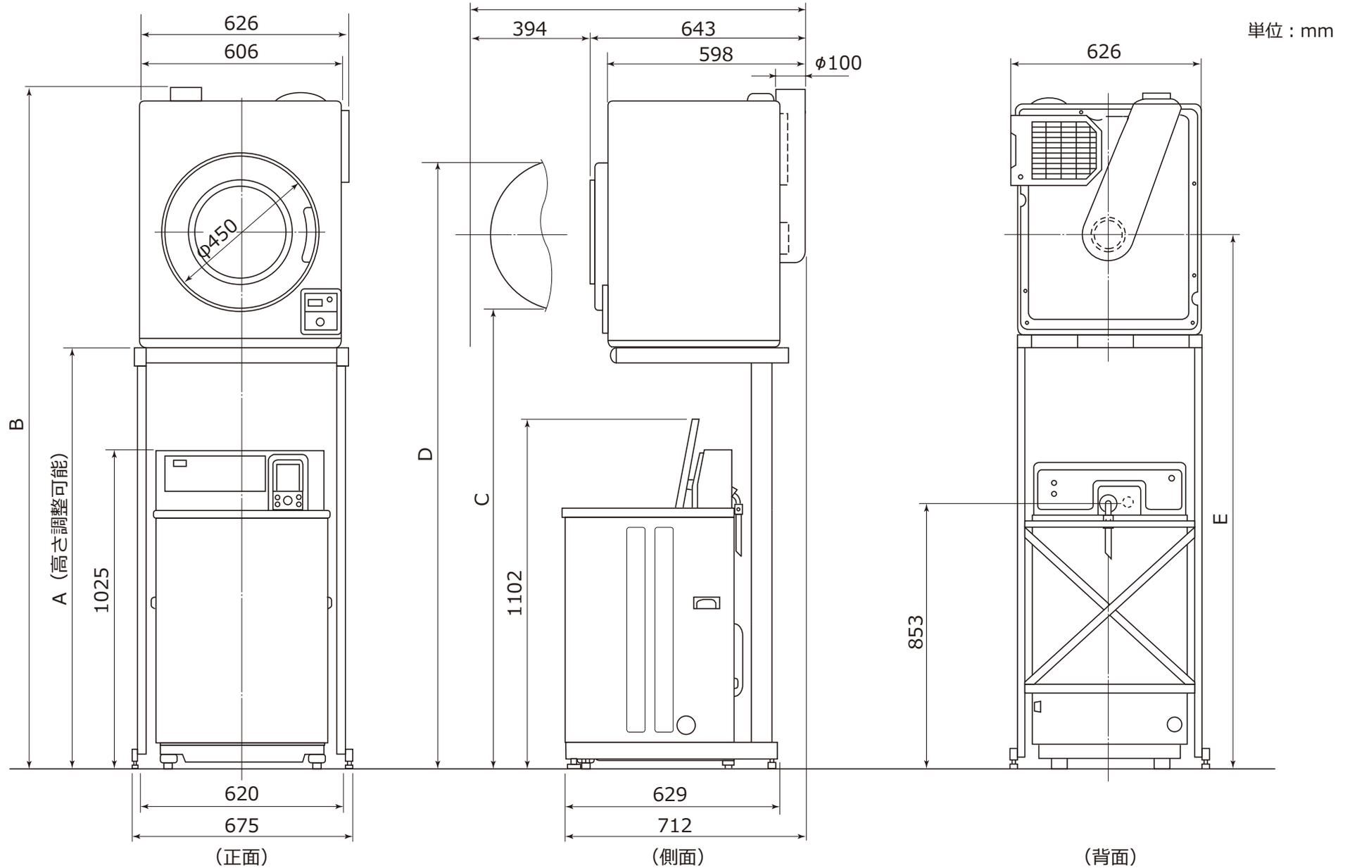
单独式洗剂自动投入器 (HHH-CLD-106) 取付时寸法图
