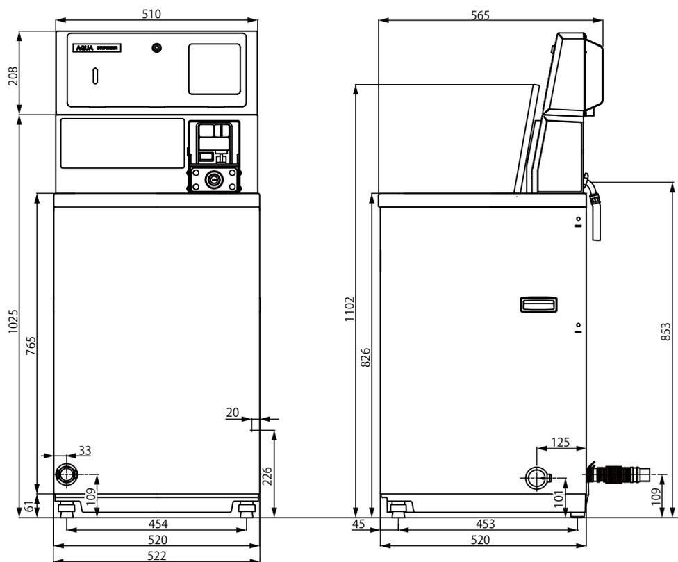
集中式洗剂自动投入器 (CLD-104) 取付时寸法图
