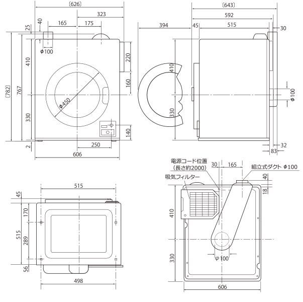
コイン式全自動洗濯機 MCW-C70L コイン式衣類乾燥機 MCD-CK50L 専用ユニット HDS-CL7 設置スペース: 左側 50mm以上
